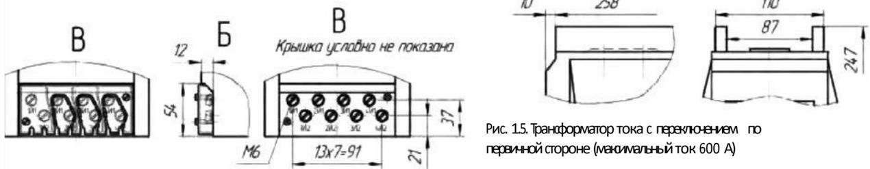
Рис. 15. Трансформатор тока с переключением по первичной стороне (максимальный ток 600 А)
