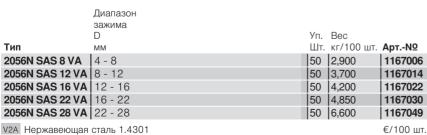
Для электрического подключения экранирующей оплетки проводов; поставляется в комплекте со скобами; зажимные скобы из нержавеющей стали VA. Экран для защиты кабеля от электромагнитного воздействия может быть использован также для уравнивания потенциалов, так как оба его конца заземлены.
