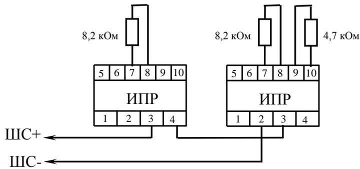
Схема подключения извещателей "Фотон-СК", тип шлейфа 5
