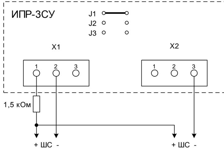
Имитация теплового датчика
