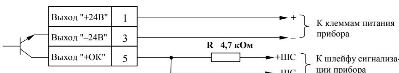
R - оконечный резистор шлейфа, устанавливается в корпусе РИП (входит в состав ЗИП приборов)
