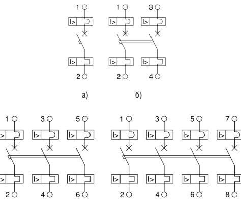
а) однополюсного; б) двухполюсного; в) трехполюсного; г) четырехполюсного.
