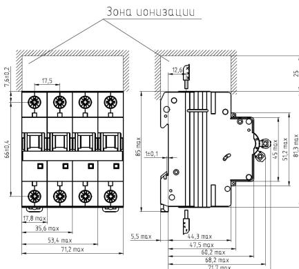
Рисунок В.1 – Габаритные и установочные размеры выключателей
