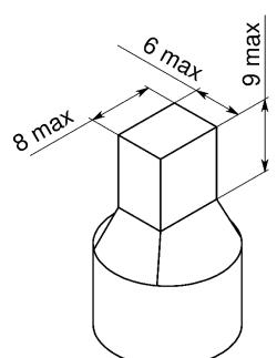
Рисунок Е.1 – Форма и размеры проводника, подготовленного для присоединения к выключателю
