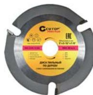
Диск пильный Cutop Profi Plus предназначен для использования совместно с УШМ и применяется для чистого и ровного реза древесины, гипсокартона, паркетных досок, фанеры, ДВП, ДСП, ПВХ, ламината. Диск имеет 3 твердосплавные напайки из карбида вольфрама, что обеспечивает: безопасность при высоких оборотах., устойчивость к деформации и воздействию температур. Материал: инструментальная сталь, зубья из карбида вольфрама. Упаковка: блистер.
