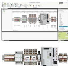
Интуитивное ПО для проектирования и маркировки клеммных колодок, а также для профессиональной печати на маркировочных материалах для клемм, проводов, кабелей, приборов и установок. ПО доступно для бесплатного скачивания
