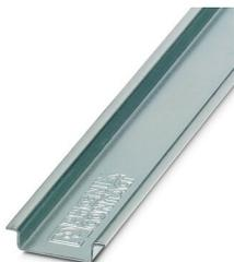
Несущая рейка без перфорации, Вариант упаковки из 25 штук (50 м), согласно EN 60715, материал: Алюминий, без покрытия, Стандартный профиль, цвет: серебристый
