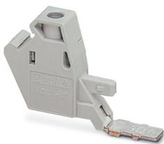
Клеммы-отводы, номинальное напряжение: 1000 В, номинальный ток: 32 А, количество точек подсоединения: 1, тип подключения: Винтовые зажимы, сечение: 0,14 мм<sup>2</sup> - 6 мм<sup>2</sup>, тип монтажа: на основной элемент, цвет: серый
