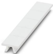
Полоса Zack, возможен заказ: в лентах, белый, надписи в соответствии с требованиями заказчика, тип монтажа: крепление в высоких пазах для табличек, для клемм шириной: 12,2 мм, размер маркировочного поля: 10,5 x 12,15 мм, Количество отдельных табличек: 5
