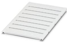
Маркировка для клеммных модулей, возможен заказ: в пластинах, белый, надписи в соответствии с требованиями заказчика, тип монтажа: крепление в высоких пазах для табличек, для клемм шириной: 6,2 мм, размер маркировочного поля: 5,6 x 10,5 мм, Количество отдельных табличек: 80
