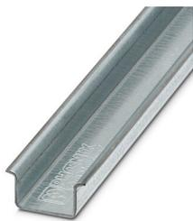
Несущая рейка без перфорации, Вариант упаковки из 25 штук (50 м), соотв. EN 60715, материал: Сталь, оцинкованный, Стандартный профиль, цвет: серебристый
