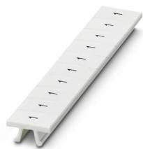
Полоса Zack, Полоса, белый, с маркировкой, маркируется с помощью: CMS-P1-PLOTTER, надписи вдоль: одинаковые номера 1 или 2 и т.д. до 100, тип монтажа: фиксировать, для клемм шириной: 6,2 мм, размер маркировочного поля: 6,15 x 10,5 мм, Количество отдельных табличек: 10
