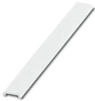
Плоские планки Zack, Полоса, возможен заказ: в лентах, белый, надписи в соответствии с требованиями заказчика, тип монтажа: крепление в плоских пазах для табличек, для клемм шириной: 6,2 мм, размер маркировочного поля: 5,15 x 6,15 мм, Количество отдельных табличек: 10
