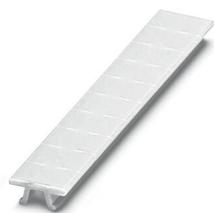
Маркировка для клеммных модулей, Полоса, белый, с маркировкой, маркируется с помощью: CMS-P1-PLOTTER, горизонтально: L1, L2, L3, N, PE, L1, L2, L3, N, PE, тип монтажа: фиксировать, для клемм шириной: 6,2 мм, размер маркировочного поля: 6,15 x 10,5 мм, Количество отдельных табличек: 10
