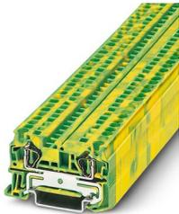
Заземляющий клеммный модуль с пружинными зажимами, количество точек подсоединения: 2, тип подключения: Пружинный зажим, 1. ярус, сечение: 0,08 мм<sup>2</sup> - 6 мм<sup>2</sup>, тип монтажа: NS 35/7,5, NS 35/15, цвет: желто-зел.
