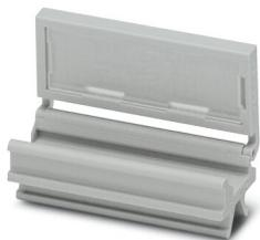
Табличка для групповой маркировки, устанавливается по центру клеммного модуля, для винтовых, пружинных клемм и клемм с системой быстрого подключения, маркируются с помощью вставных полос ESL 26 x 6 мм или EST 25 x 6 мм, нижняя часть с полосой Zack, длина: 29 мм
