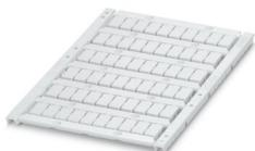
Маркировка для клеммных модулей, возможен заказ: в пластинах, белый, надписи в соответствии с требованиями заказчика, тип монтажа: крепление в высоких пазах для табличек, для клемм шириной: 6,2 мм, размер маркировочного поля: 5,6 x 10,5 мм, Количество отдельных табличек: 60
