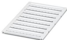
Маркировка для клеммных модулей, возможен заказ: в пластинах, белый, надписи в соответствии с требованиями заказчика, тип монтажа: крепление в плоских пазах для табличек, для клемм шириной: 6,2 мм, размер маркировочного поля: 5,6 x 5,1 мм, Количество отдельных табличек: 80
