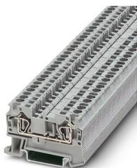
Проходные клеммы, номинальное напряжение: 800 В, номинальный ток: 32 А, количество точек подсоединения: 2, тип подключения: Пружинный зажим, 1. ярус, Расчетное сечение: 4 мм<sup>2</sup>, сечение: 0,08 мм<sup>2</sup> - 6 мм<sup>2</sup>, тип монтажа: NS 35/7,5, NS 35/15, цвет: серый
