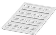
Маркировка для клеммных модулей, возможен заказ: в пластинах, белый, надписи в соответствии с требованиями заказчика, тип монтажа: крепление в плоских пазах для табличек, для клемм шириной: 5,2 мм, размер маркировочного поля: 4,6 x 5,1 мм, Количество отдельных табличек: 96
