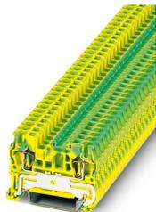
Заземляющий клеммный модуль с пружинными зажимами, количество точек подсоединения: 2, тип подключения: Пружинный зажим, сечение: 0,08 мм<sup>2</sup> - 4 мм<sup>2</sup>, тип монтажа: NS 35/7,5, NS 35/15, цвет: желто-зел.
