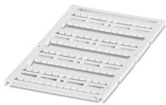
Маркировка для клеммных модулей, Пластина, белый, без надписи, маркируется с помощью: BLUEMARK ID COLOR, BLUEMARK ID, BLUEMARK CLED, PLOTMARK, CMS-P1-PLOTTER, тип монтажа: фиксировать, для клемм шириной: 5,2 мм, размер маркировочного поля: 4,6 x 5,1 мм, Количество отдельных табличек: 96
