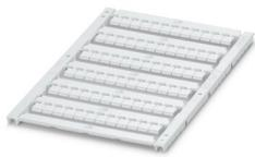
Маркировка для клеммных модулей, Пластина, белый, без надписи, маркируется с помощью: TOPMARK NEO, TOPMARK LASER, BLUEMARK ID COLOR, BLUEMARK ID, BLUEMARK CLED, THERMOMARK PRIME, THERMOMARK CARD 2.0, THERMOMARK CARD, тип монтажа: фиксировать, для клемм шириной: 5,2 мм, размер маркировочного поля: 4,4 x 4,7 мм, Количество отдельных табличек: 72
