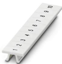
Полоса Zack, Полоса, белый, с маркировкой, надписи вдоль: нумерация по порядку 1 ...10, 11 ...20 и т.д. до 491 ...500, тип монтажа: фиксировать, для клемм шириной: 5,2 мм, размер маркировочного поля: 5,15 x 10,5 мм, Количество отдельных табличек: 10
