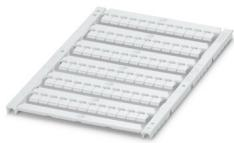
Маркировка для клеммных модулей, возможен заказ: в пластинах, белый, надписи в соответствии с требованиями заказчика, тип монтажа: крепление в плоских пазах для табличек, для клемм шириной: 5,2 мм, размер маркировочного поля: 4,4 x 4,7 мм, Количество отдельных табличек: 72
