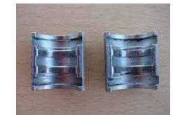
3.1. Усилие, прикладываемое к рукояткам инструмента (1), с помощью зубчатого механизма передается на выдвижной шток пресс - головки (2), который, сближая две полубоймы (4), скрепленные замком (3), воздействует на закрепленные в них пресс – вкладыши (5).
