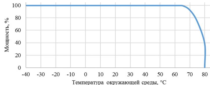
Зависимость мощности при максимальной нагрузке от температуры точки T<sub>c</sub>.
