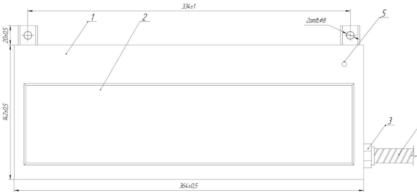
*1 корпус; 2 прозрачное окно; 3 кабельный ввод; 4 кабель питания (постоянно присоединен); 5 индикатор «СЕТЬ».*
