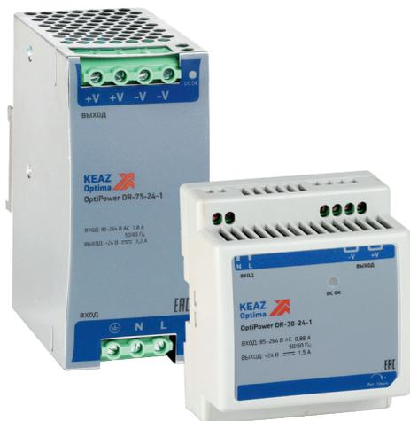
Универсальные однофазные блоки питания OptiPower серий DR и MDR являются импульсными AC/DC преобразователями напряжения с креплением на DIN-рейку, обеспечивают питание различных устройств автоматики стабилизированным напряжением постоянного тока 24 В и защиту от перегрузки, перенапряжения и короткого замыкания на выходе.
