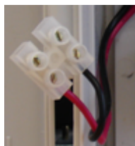
Рисунок 10. Клеммы для подключения замка к блоку питания
