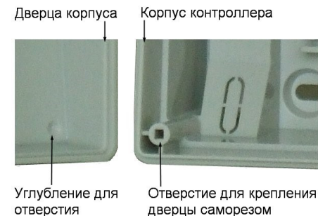
Рисунок 5. Схема «жесткого» крепления дверцы к корпусу контроллера
