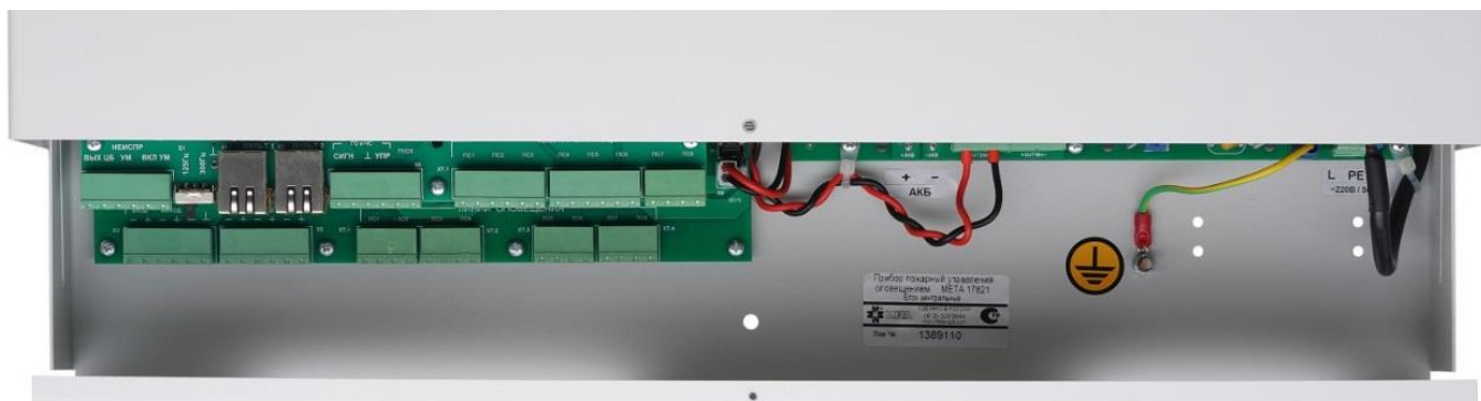
Рисунок 3. Клеммы (элементы коммутации) ЦБ МЕТА 17820/17821.
