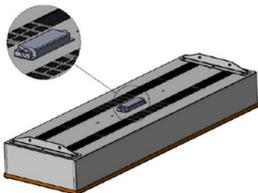
4. Совместить отверстия в кронштейнах на корпусе с отверстиями в потолочных кронштейнах используя винты M5 (входят в комплект поставки).
