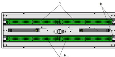
6. Для модифікації Оlymріс LED80 налаштувати необхідний кут встановлення світильника (20, 40 град.) шляхом поєднання технологічних отворів в кронштейнах і фіксації гвинтами М5.
