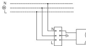
2. Схема подключения светильника к питающей сети с регулируемым драйвером по системе DALI .
