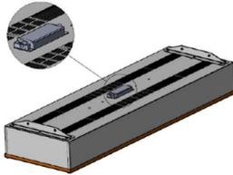
4. Поєднати отвори у кронштейнах на корпусі з отворами у стельових кронштейнах використовуючи гвинти М5 (входять до комплекту поставки).
