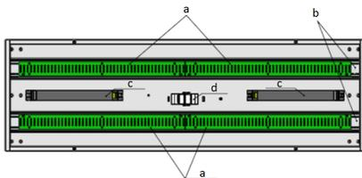
6. Для модификации Olympic LED80 настроить требуемый угол установки светильника (20, 40 град.) путём совмещения технологических отверстий в кронштейнах и фиксации винтами M5.
