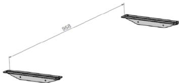
2. Распакованный светильник закрепить на потолочных кронштейнах, идущих в комплекте.
