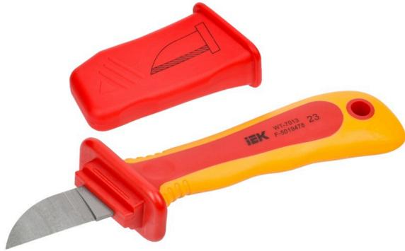
Нож прямой серии ARMA2L 3 K1 предназначен для резки и снятия оболочки кабелей. Позволяет работать под напряжением до 1000 В. Инструментальная хром-ванадиевая сталь.
