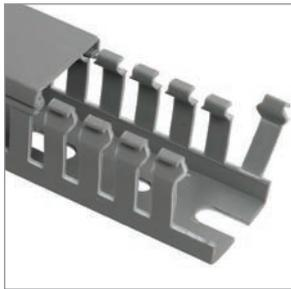
Все перфорированные кабель-каналы серии «ИМПАКТ» имеют специальную насечку у основания зубца. Благодаря этой риске ламель отламывается ровно, не оставляя зазубрин на основании канала. Такое решение позволяет исключить повреждение изоляции провода при заведении его в канал.
