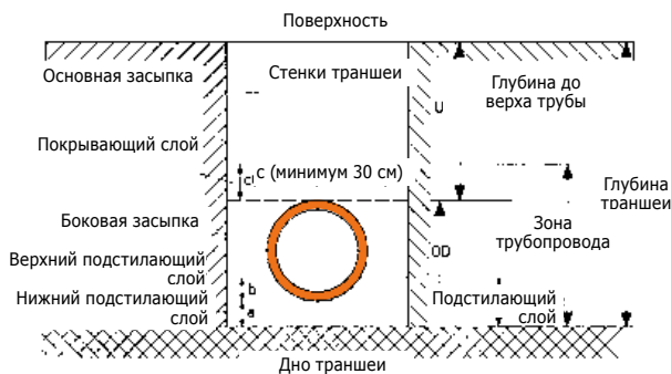
Рис. 3 Устройство траншеи
