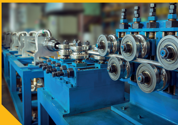
Линия охлаждения гофрированной трубы Stahlmann после отжига
