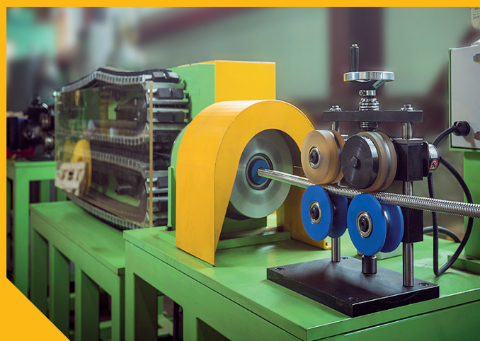
Процесс гофрирования трубы
