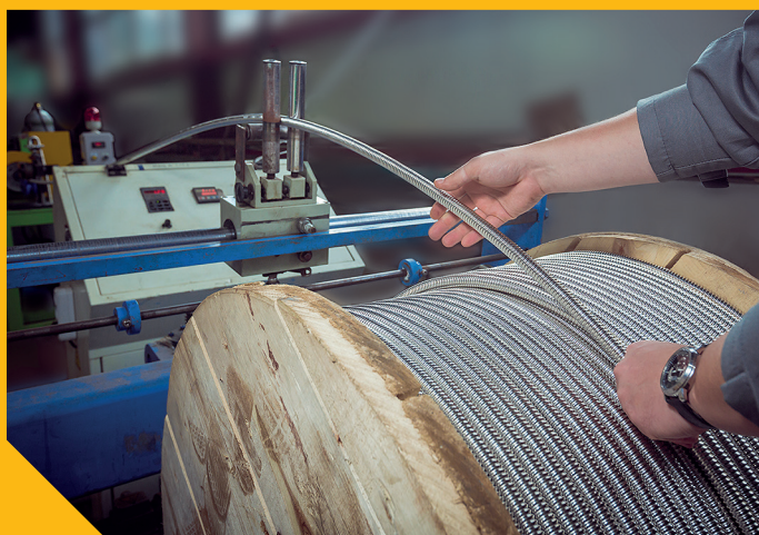
Подача гофрированной трубы Stahlmann для отжига
