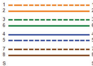
Схема разводки (T568B) PASS
