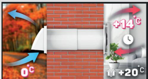
В автоматическом режиме при включении рекуператор вытягивает воздух из помещения. По истечении установленного времени переключения (60, 70, 80, либо 90 сек.), происходит автоматическое переключение на приток. При уличной температуре 0 °C на приток будет поступать воздух +14 °C. Приток, как и вытяжка, продолжается установленное время. Далее происходит переключение на вытяжку.
