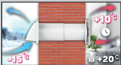
В автоматическом режиме при включении рекуператор вытягивает воздух из помещения. По истечении установленного времени переключения (60, 70, 80, либо 90 сек.), происходит автоматическое переключение на приток. При уличной температуре -15 °C на приток будет поступать воздух +10 °C. Приток, как и вытяжка, продолжается установленное время. Далее происходит переключение на вытяжку.
