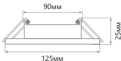
Светодиодный светильник CD9913 разработан специально для натяжных потолков и подвесных систем.
