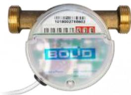
СВК-15-3-2-Б проводной универсальный счётчик холодной и горячей воды СВК 15-3-2 1/2" (Ду=15, L=110 мм) с модулем Болид "С2000-АСР1", сгонами и обратным клапаном.
