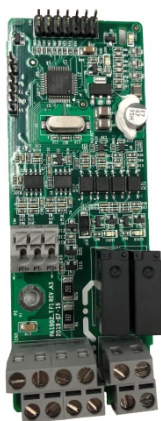
Плата расширения ввода-вывода 2 SEOP-1631
