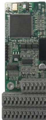
Плата инкрементального энкодера SEOP-1523
