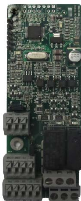
Плата расширения ввода-вывода 1 SEOP-1628
