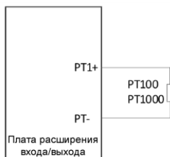
Рисунок 5-25 PT100/PT1000, измеряющий температуру через плату расширения
