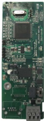
Плата связи управления master/slave CANopen/CAN SEOP-1307
