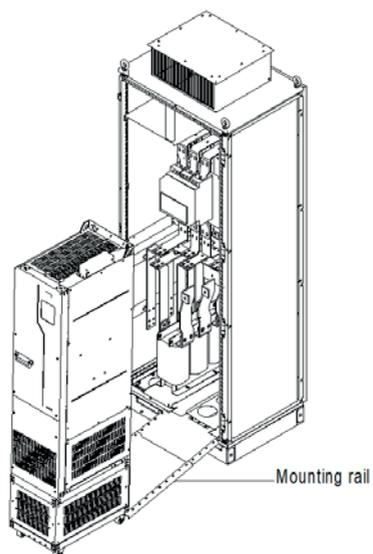
Рис. 4–15 Выравнивание роликов ПЧ с монтажной рейкой
