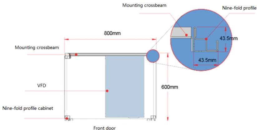
Рис. 4–11 Вид сверху крепления STV600C28N4–STV600C50N4 в шкафу
