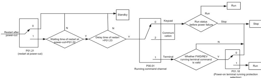
2. Логическая схема запуска после автоматического сброса неисправности
