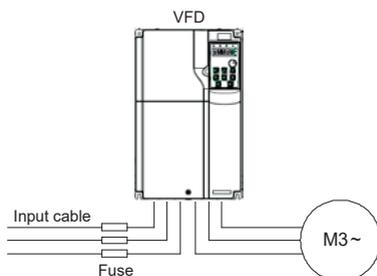
Рис. 4–33 Подключение предохранителей
