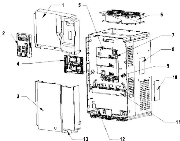
Рис. 3-5 Конструкция ПЧ
