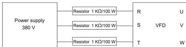
Рис. 8-3 Пример схемы зарядки ПЧ 380 В
