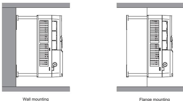
Рис. 4-2 Способ установки
