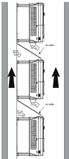
Рис. 4-5 Вертикальная установка
