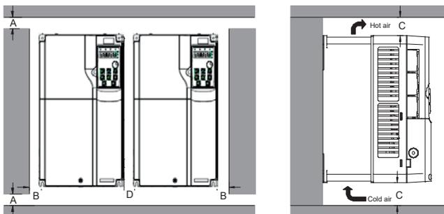
Рис. 4-4 Параллельная установка
