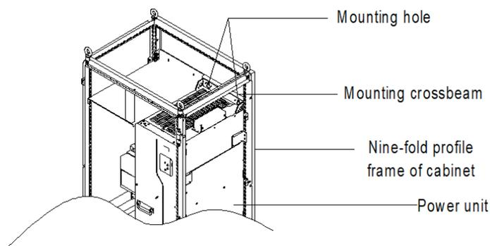
Рис. 4–12 Трёхмерный вид крепления STV600C28N4–STV600C50N4 в шкафу
