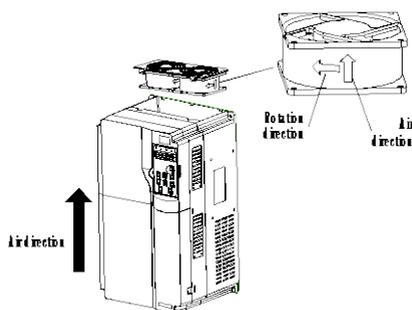
Рис. 8-1 Обслуживание вентиляторов для моделей ПЧ 30кВт–200кВт
