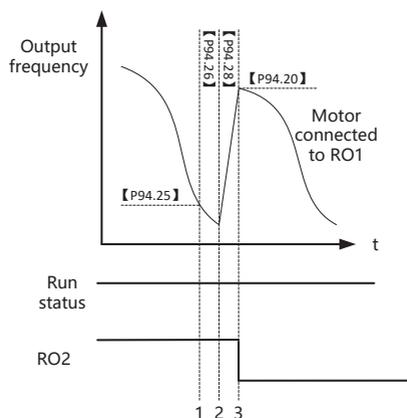
Рис. 5–9 Диаграмма времени снижения частоты двигателя
