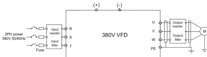
Рис. 4–19 Схема подключения основной цепи AC 3ф 380В
