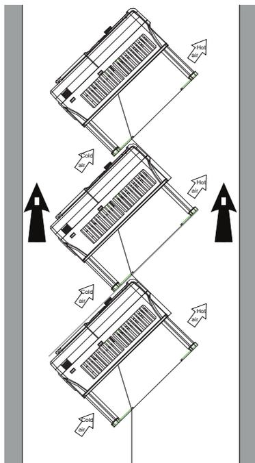
Рис. 4-6 Наклонная установка
